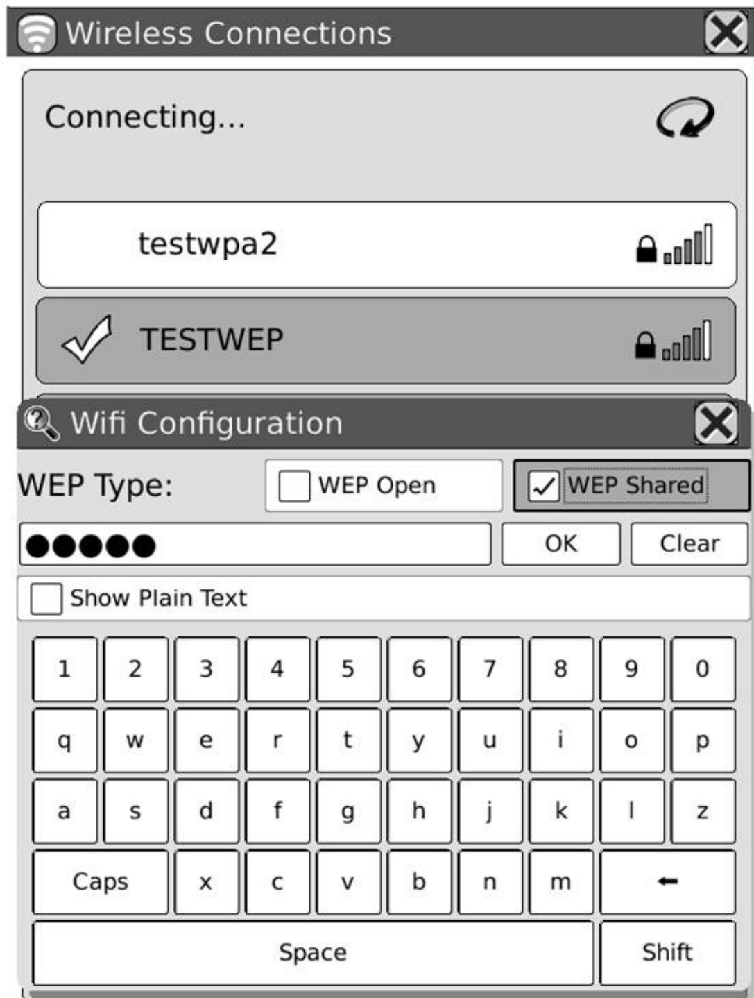
Fig. 7.12.5 Schermafbeelding van configuratie met WEP beveiligd toegangspunt
