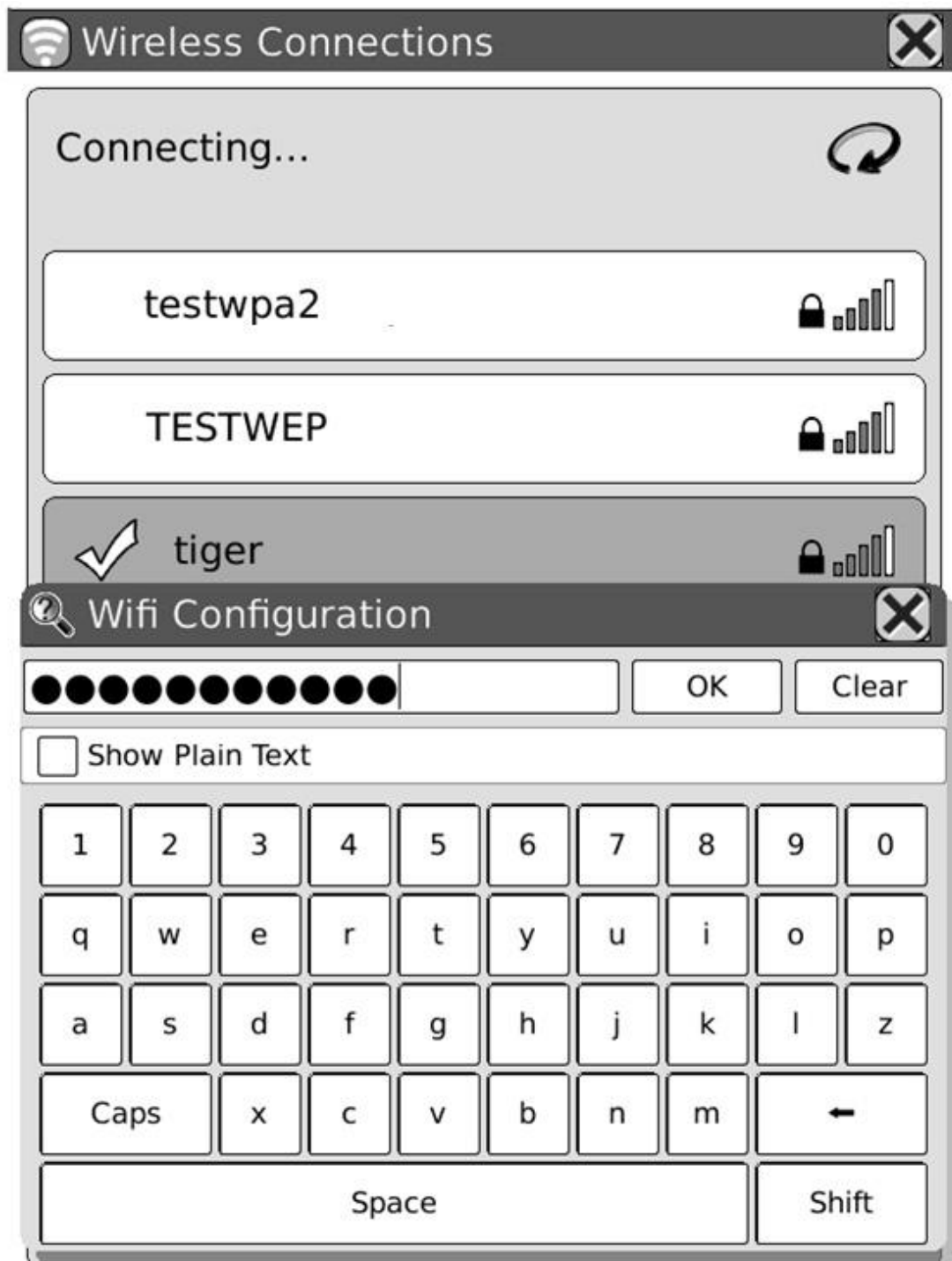
Fig. 7.12.4 Schermafbeelding van configureren van met WPA beveiligd toegangspunt
