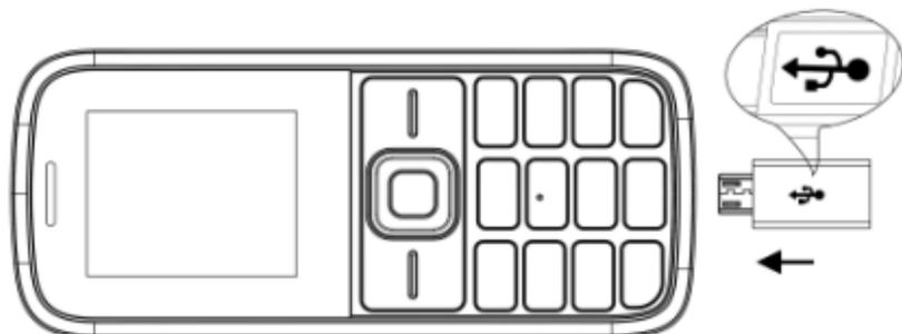
1. Schließen Sie das Ladegerät am Ladeanschluss an der unteren Seite des Telefons an.
